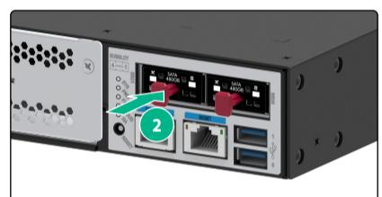
拆下硬盘卡槽假面板
